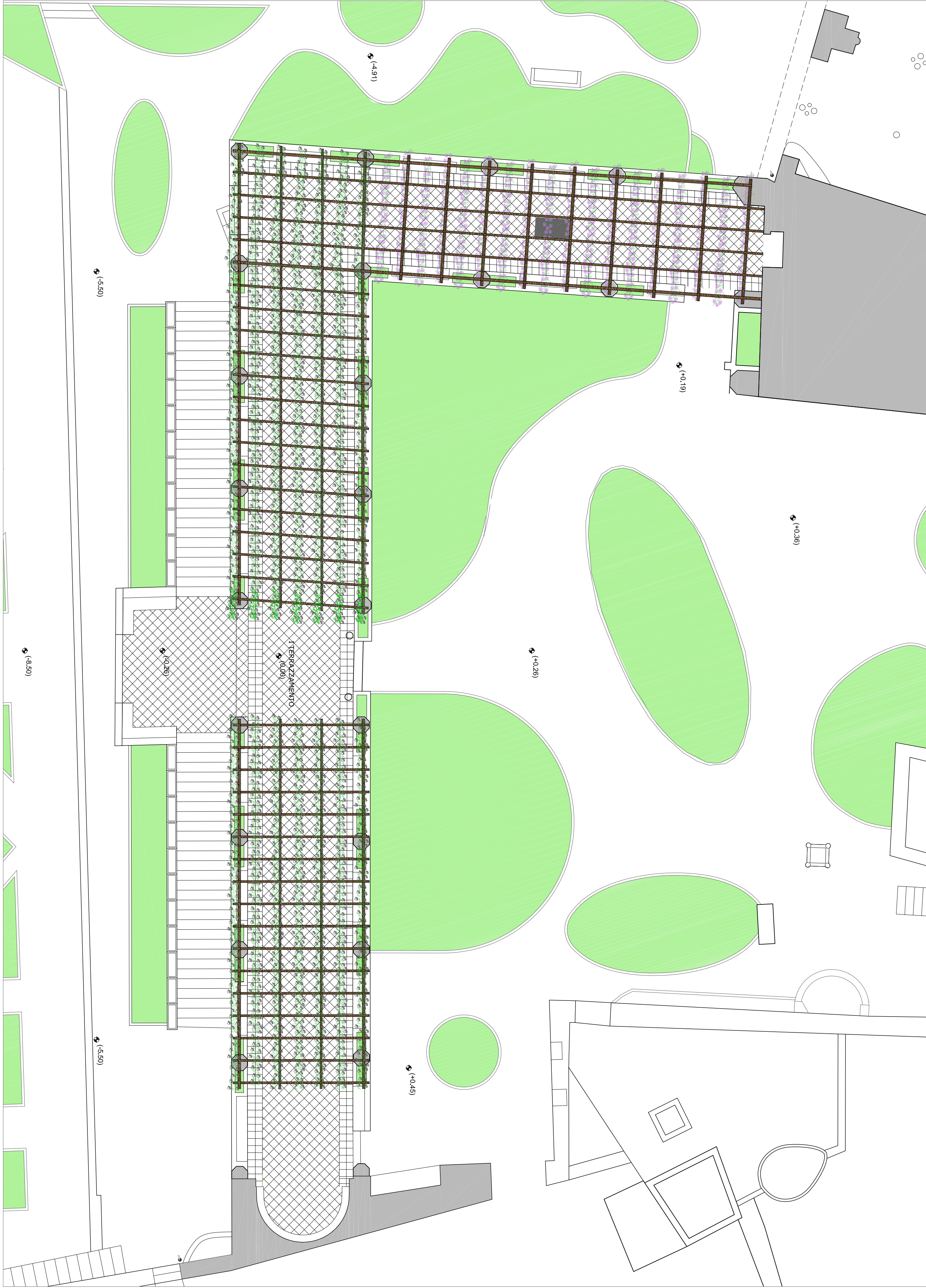
STATO DI PROGETTO- Pianta delle coperture del terrazzamento con nuovo pergolato (a 361,24 mt. attuale quota 0,00) Scala 1:100
